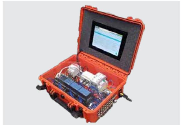
Abbildung 1: Messkoffer für die elektrische Leistungsmessung (Ioshchikhes et al. (2022))
