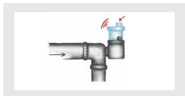
Abbildung 4: SmartAir-Sensorik, die auf einen klassischen Entlüfter aufgesetzt wird
